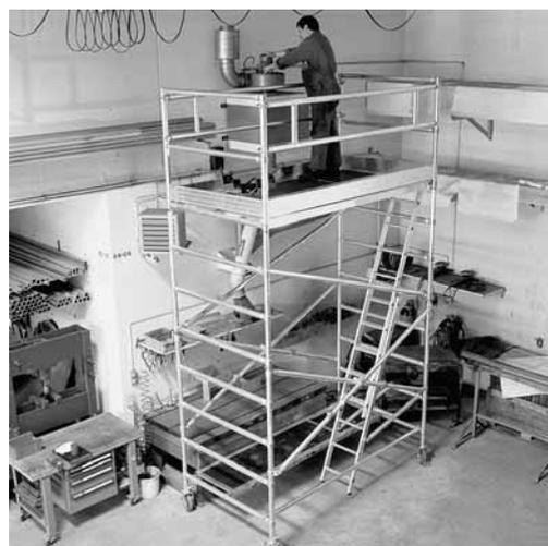
Figure 6: l'absence de protection latérale et un platelage défectueux entraînent souvent la chute de personnes.
