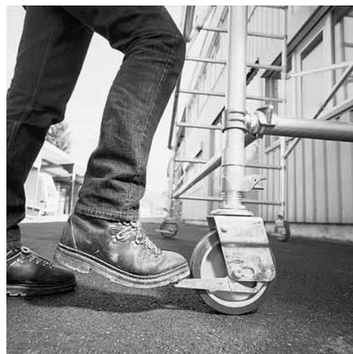
Figure 4: seules des roues bloquées évitent un déplacement involontaire de l'échafaudage roulant.
